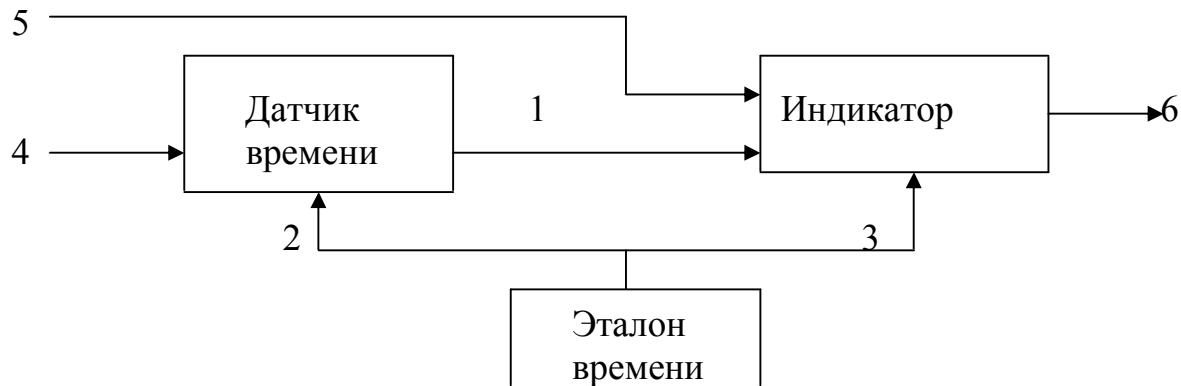
Рисунок 4.3 – Структурная схема системы «синхронизируемые часы»
