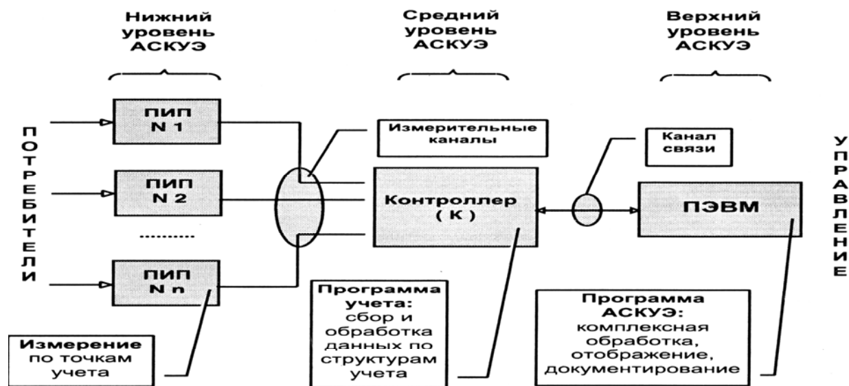
Рис.6.2. Обобщенная трехуровневая схема АСКУЭ
