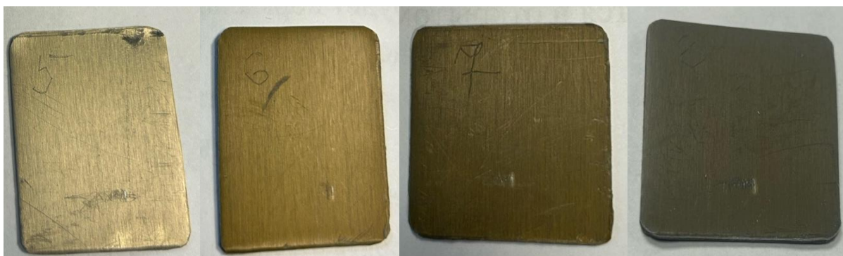
Рис. 1. Образцы из алюминия марки A0H после 1, 2, 3 и 4 часов анодирования соответственно Fig. 1. Samples of aluminum grade A0N after 1, 2, 3 and 4 hours of anodizing, respectively.
