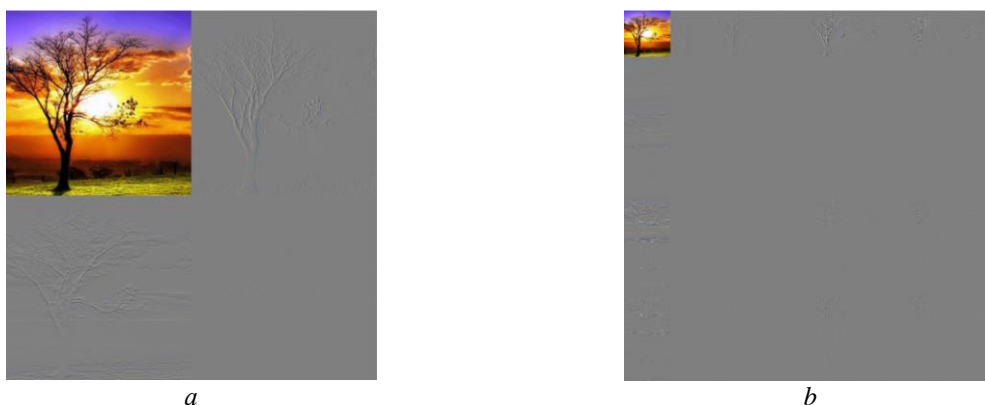
Рис. 2. Разложение изображения методом ДВП: a – 1 уровень; b – 3 уровня Fig. 2. Image decomposition using the DWT: a – 1 level; b – 3 levels
