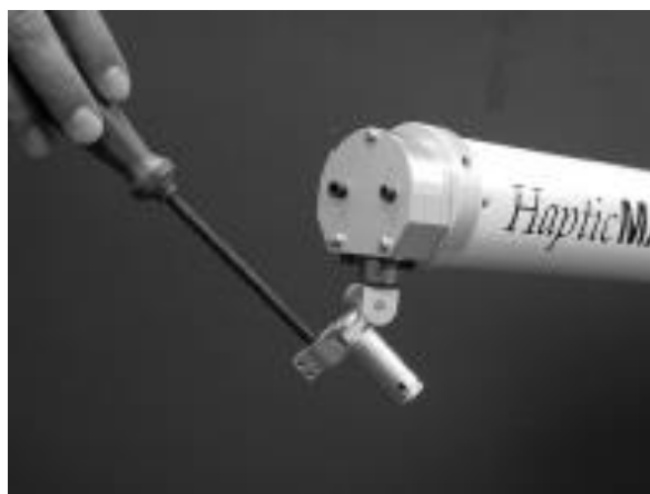
Рисунок 1.7 – Концевой эффектор, на котором закреплена отвертка
