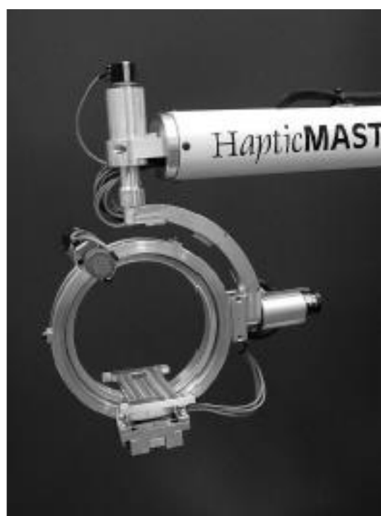
Рисунок 1.8 – Концевой эффектор с двумя пассивными и одной активной степенями свободы
