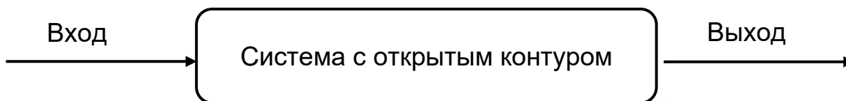
Рисунок 1.2 – Система управления без обратной связи
