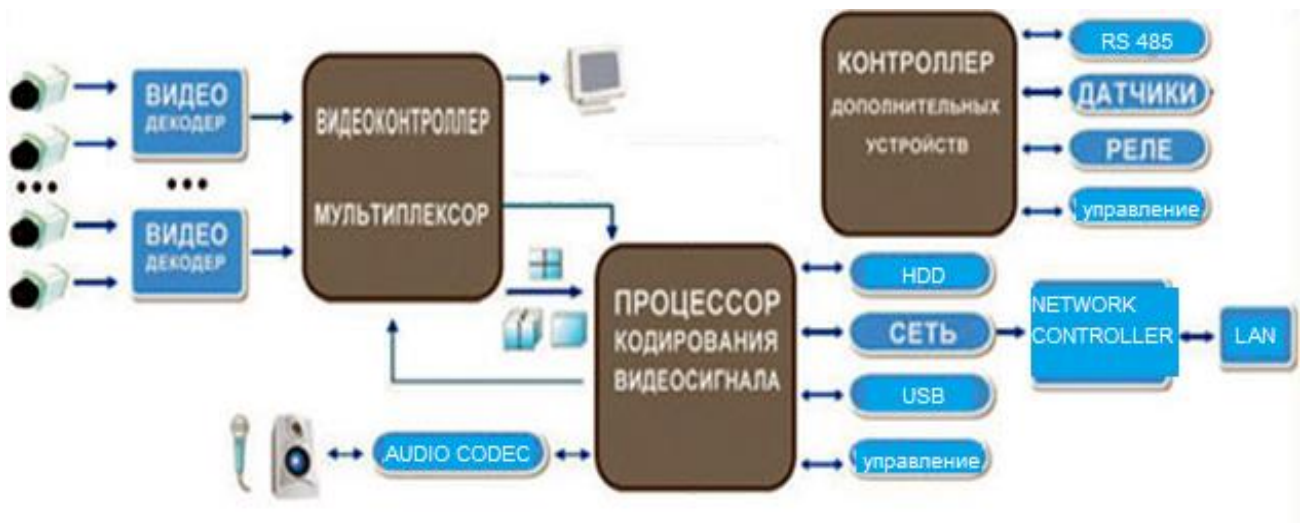
Рисунок 3.10 – Общая схема цифрового видеорегистратора
