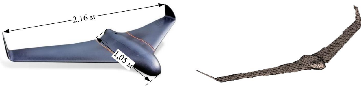
Рис. 1. Внешний вид БЛА Skywalker-X8 и его трехмерная модель
