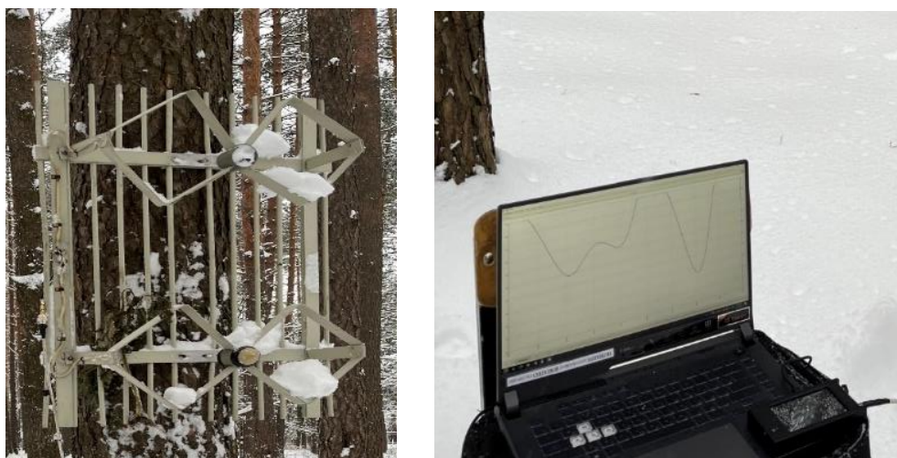
Рис. 1. Проведение измерений параметров АУ при наличии на антенне снежного покрова и обледенения
