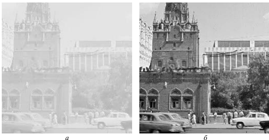
Рис. 2. Пример использования процедуры линейного контрастирования: а – полутоновое изображение со значениями яркости x_{\min} = 180, x_{\max} = 240 ; б – результат линейного контрастирования и приведение динамического диапазона к значениям y_{\min} = 0, y_{\max} = 255
