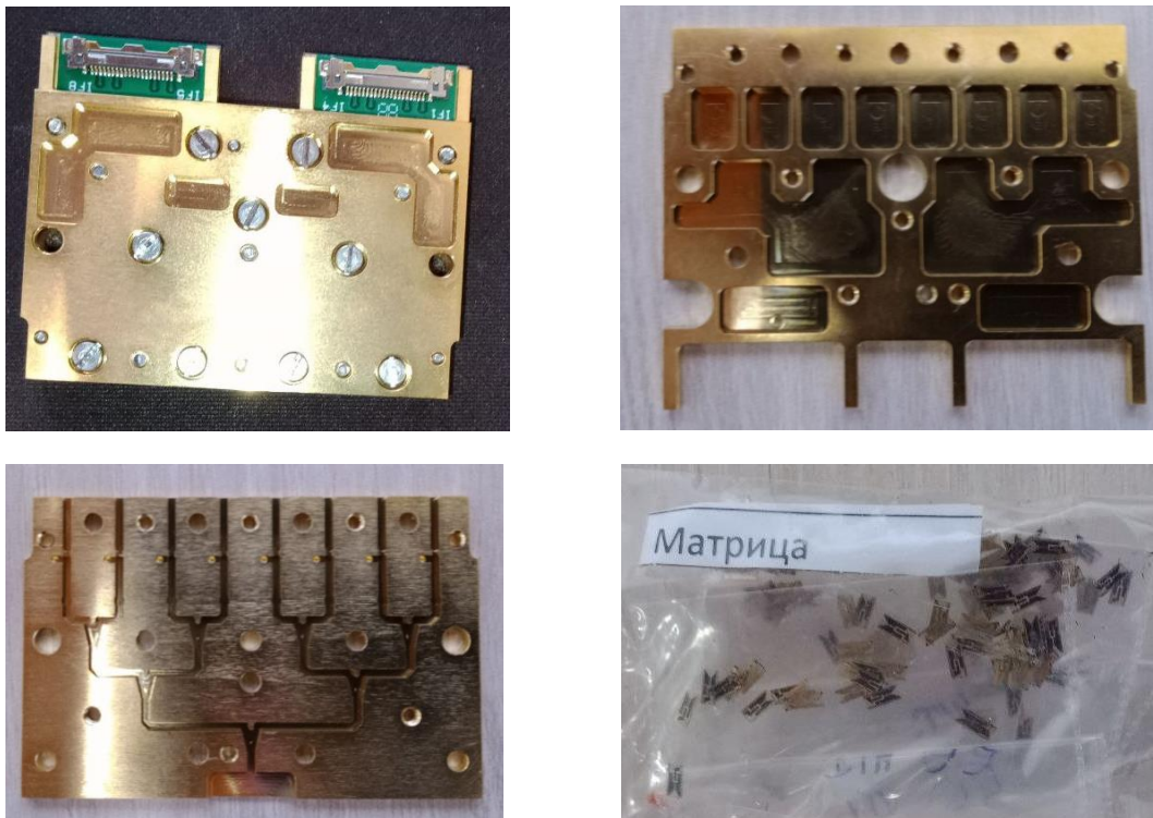
Рис. 8. Восьмиканальный супергетеродинный приемник 94 ГГц
