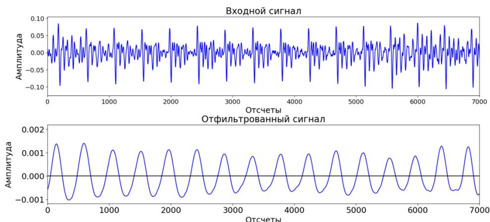
Рис. 2. Входной сигнал и отфильтрованный сигнал
