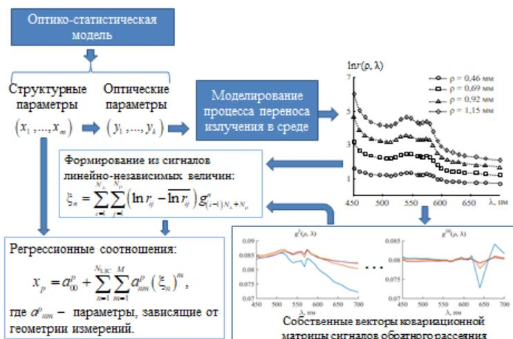
Рис.1. Функциональная схема регрессионного подхода
