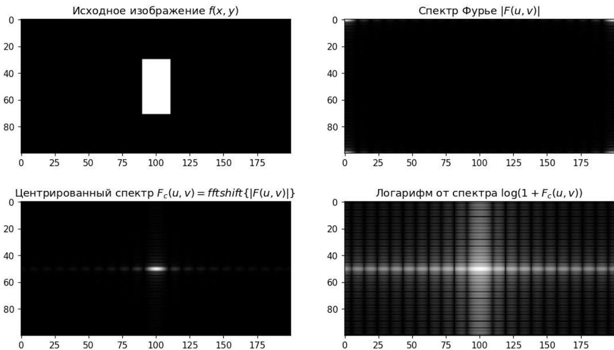
Рисунок 2 – Вычисление центрированного ДПФ из нецентрированного путем разбиения массива на четыре квадранта и их диагональной перестановки
