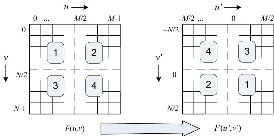
Рисунок 1 – Вычисление центрированного ДПФ из нецентрированного путем разбиения массива на четыре квадранта и их диагональной перестановки
