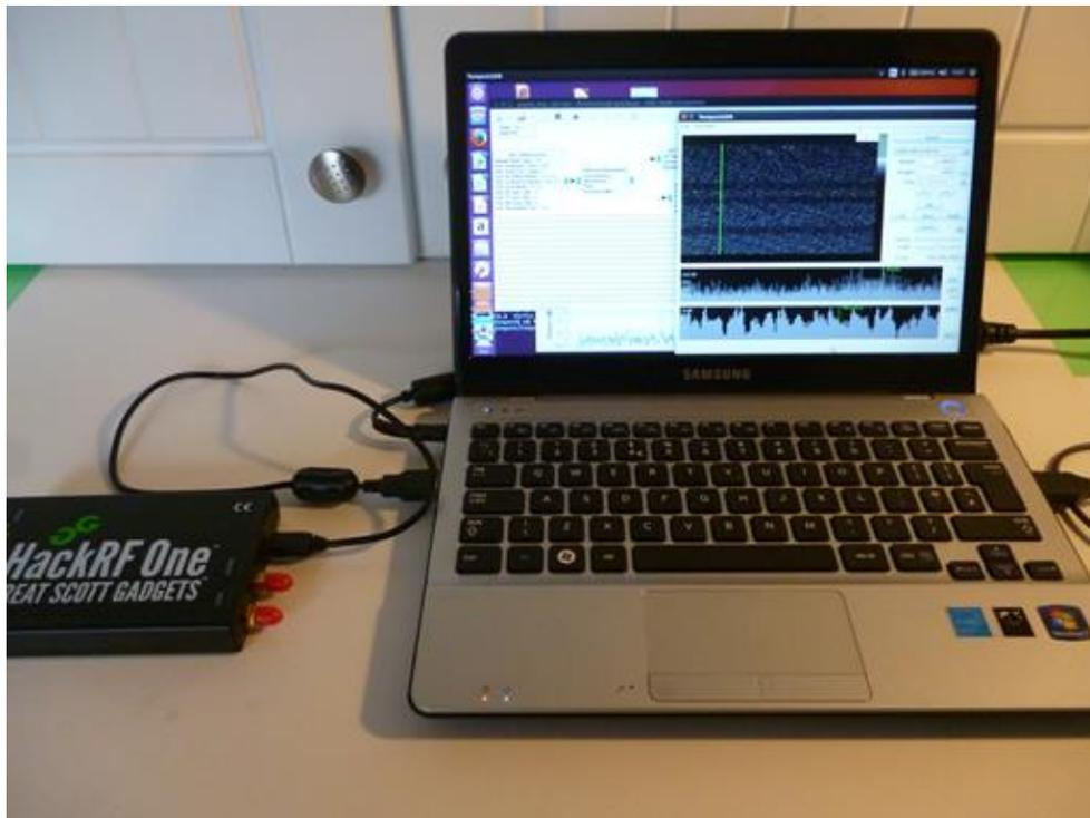
Рисунок 1 Устройство радиомониторинга каналов управления БЛА
