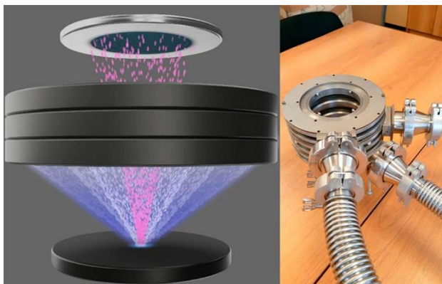
Рисунок 3 – Ионно-лучевой испаритель (ИЛИ) – Ионно-лучевая пушка [4]
