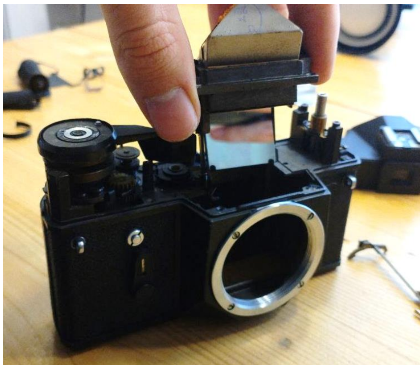
Рисунок 6 – Извлечение пентапризмы и зеркала из «Зенит ЕТ»
