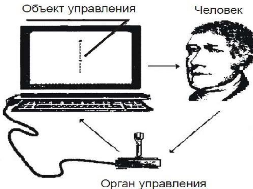
Рисунок 1 – Обобщенная схема установки для тестирования
