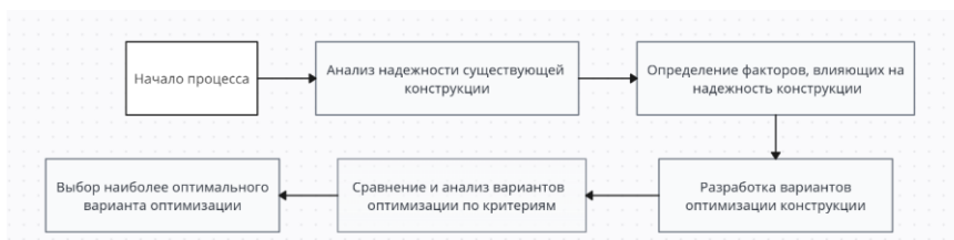
Рисунок 4 – Блок-схема метода оптимизации высоконадежных конструкций радиоэлектронных средств
