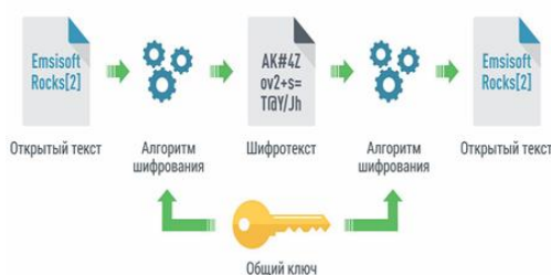
Рисунок 1 – Схема работы симметричного шифрования
