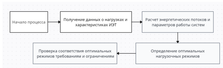
Рисунок 2 – Блок-схема методики определения оптимальных нагрузочных режимов интегральных электронных устройств
