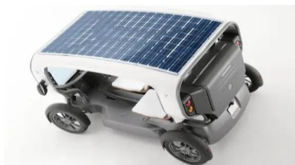
Рисунок 3 - Солнечные батареи на крыше Venturi Eclectic
