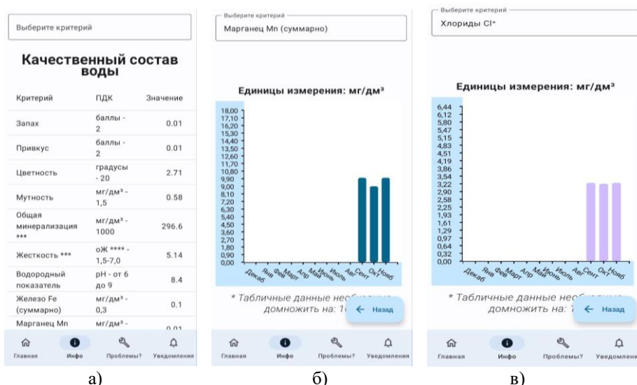
Рисунок 2 - Раздел «Инфо» клиент-серверного приложения: а) таблица со значениями концентраций различных веществ в питьевой воде; б) график содержания марганца в питьевой воде; в) график содержания хлоридов в питьевой воде
