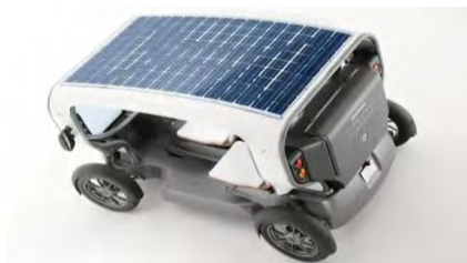
Рисунок 3 - Солнечные батареи на крыше_Venturi Eclectic
