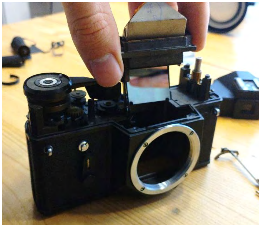
Рисунок 6 – Извлечение пентапризмы и зеркала из «Зенит ЕТ»
