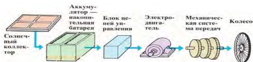
Рисунок 2 - Принцип работы гелиомобиля
