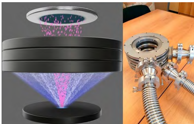
Рисунок 3 – Ионно-лучевой испаритель (ИЛИ) – Ионно-лучевая пушка [4]
