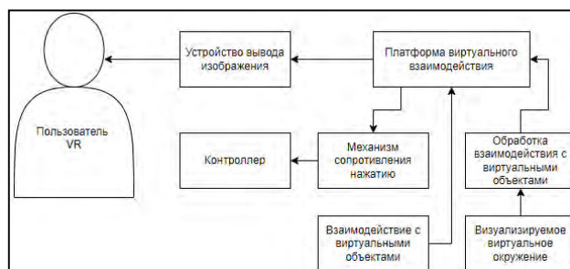
Рисунок 2 – Схематическое изображение архитектуры системы VR-взаимодействия
