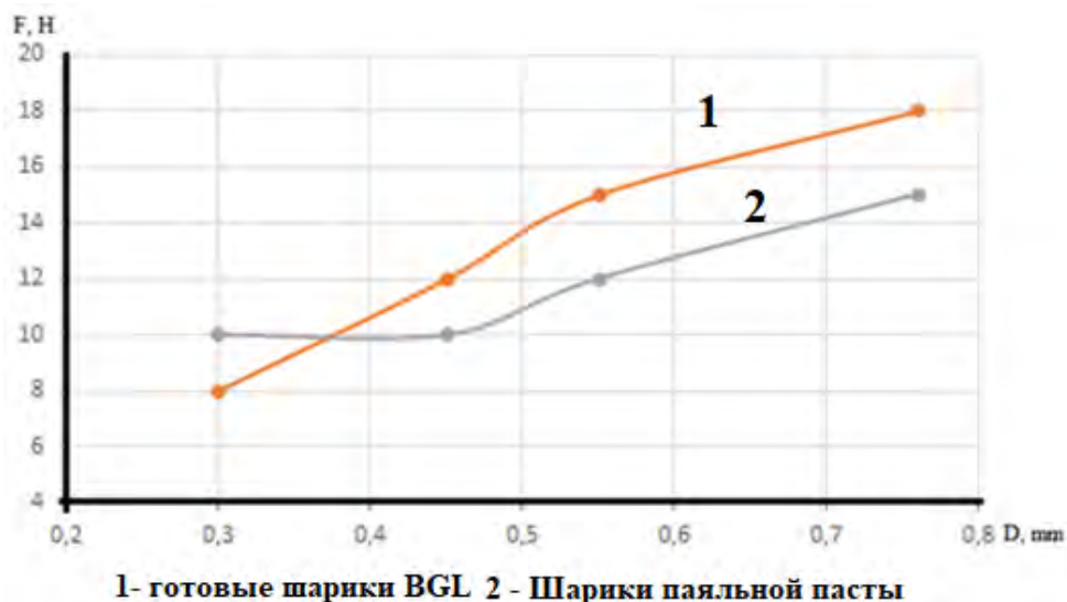
Рисунок 4 – Зависимость усилия сдвига шариков припоя от их диаметра
