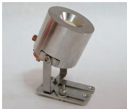
Рисунок 2 – Ионно-лучевой источник с анодным слоем - EPOS-IS-AL [3]
