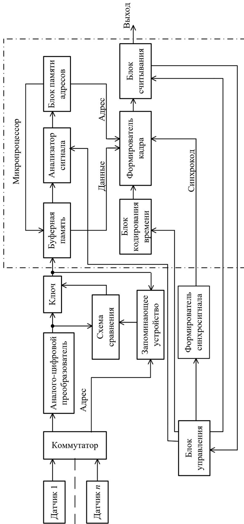
Рисунок 3.39 – Пример структурной схемы микропроцессорной телеметрической системы
