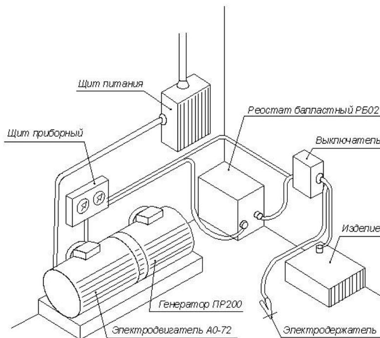
Рисунок 3.37 – Схема электрическая расположения электросварочного поста
