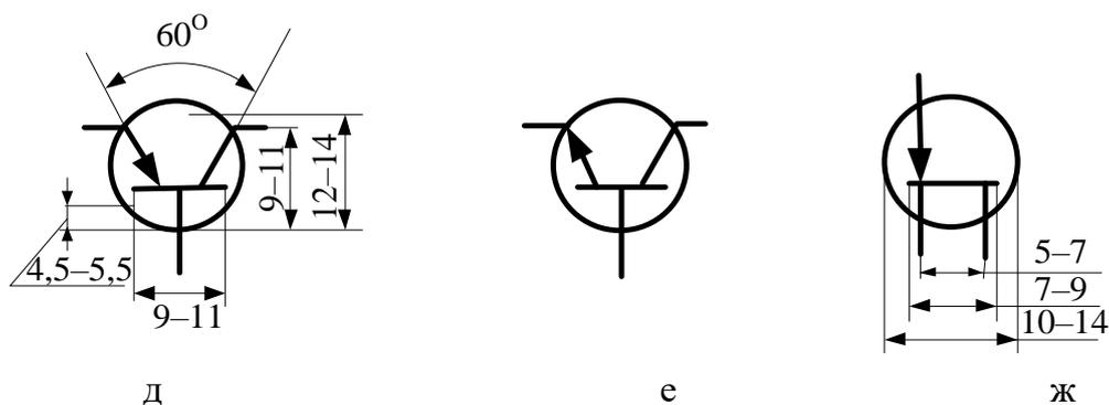
Рисунок 3.10 – Условные графические обозначения полупроводниковых приборов (к пункту 3.3.7)
