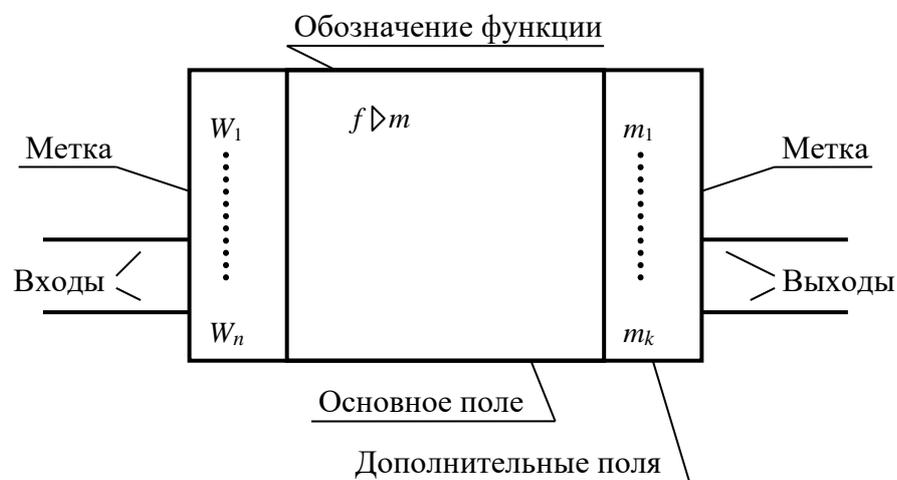
Рисунок 3.16 – Условное графическое обозначение элементов аналоговой техники (к пункту 3.5.2)
