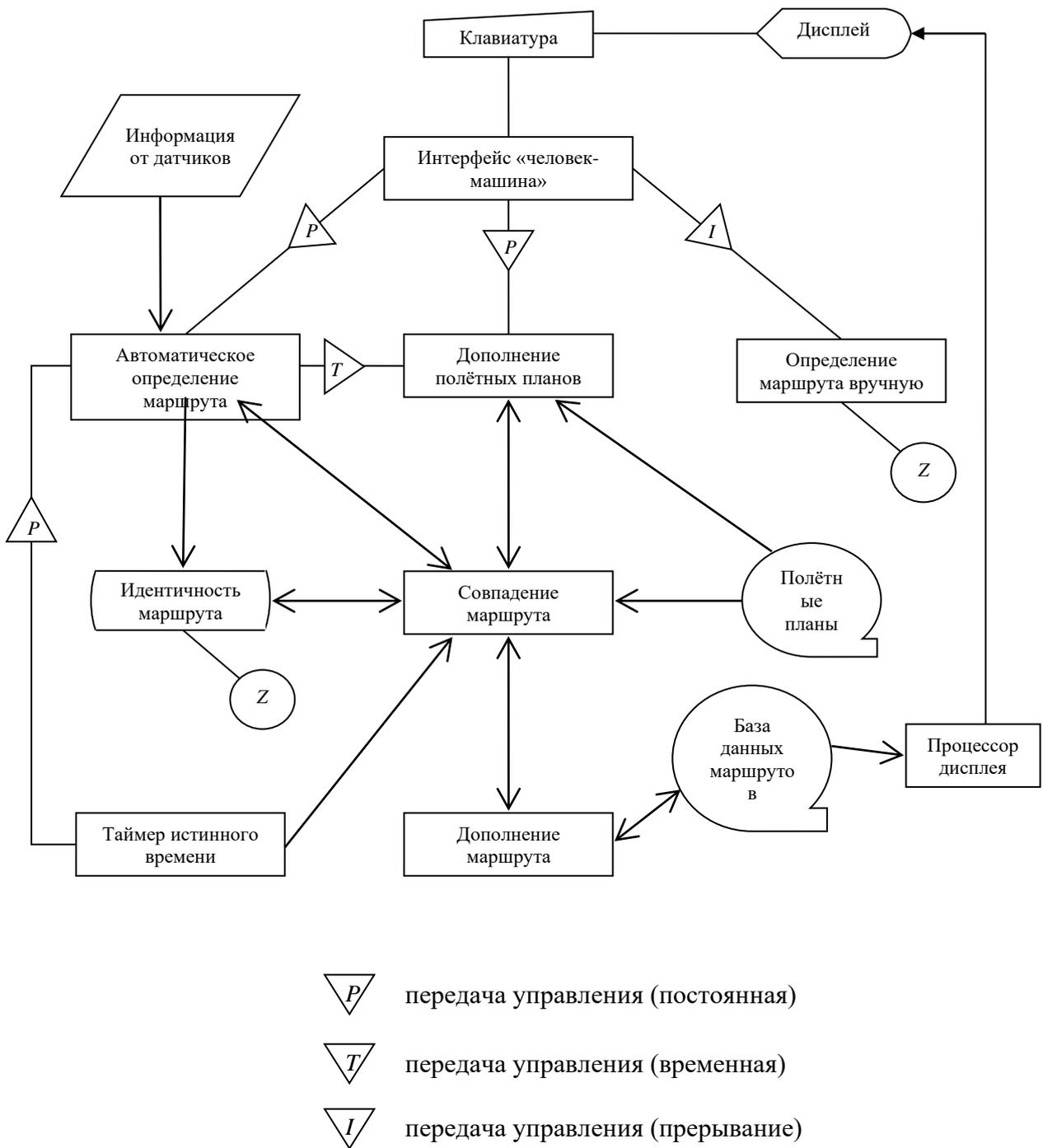
Рисунок 3.31 – Схема взаимодействия программ
