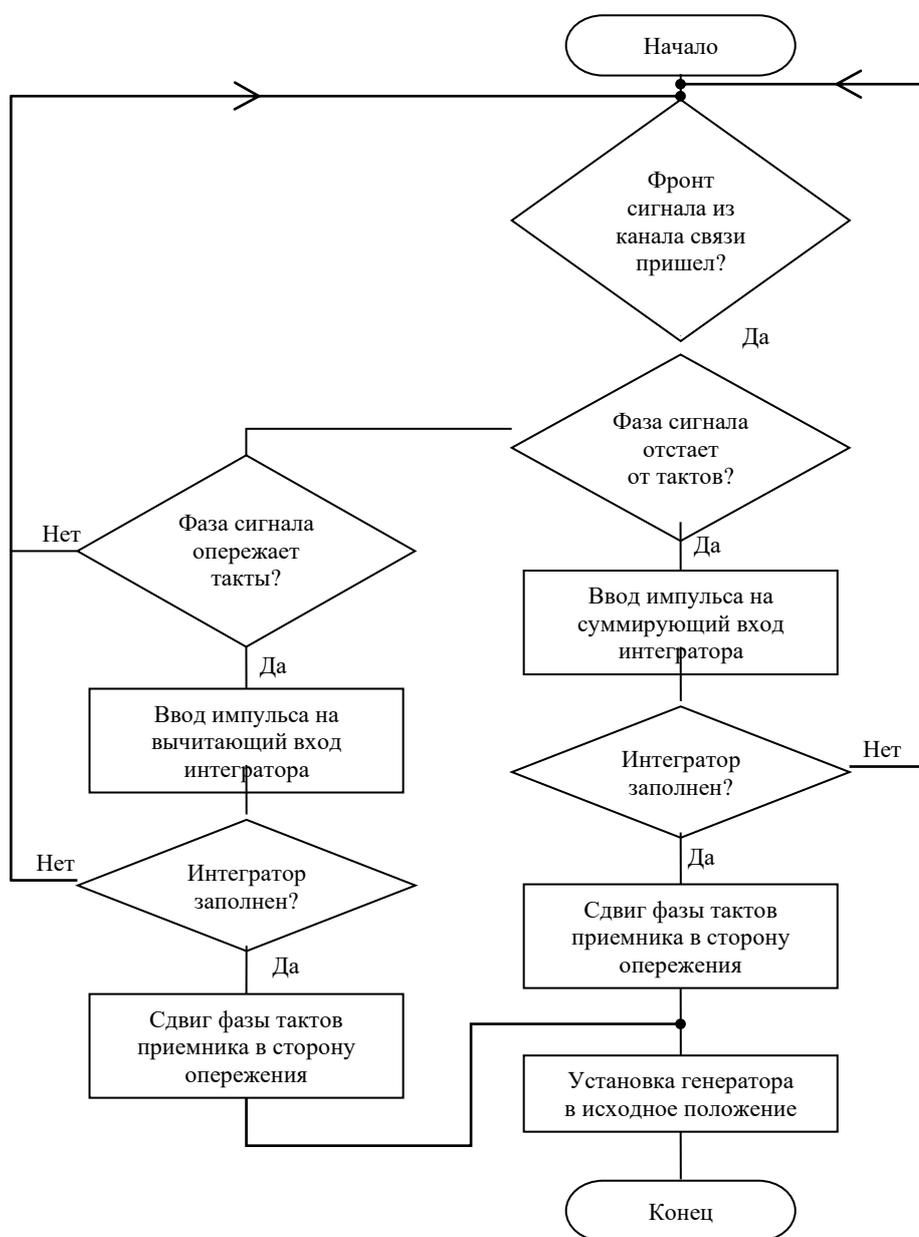
Рисунок 3.33 – Схема алгоритма работы устройства
