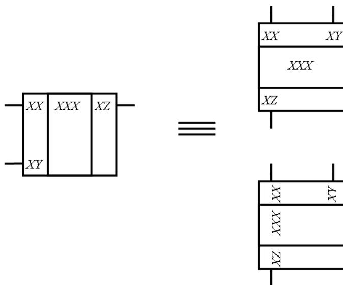
Рисунок 3.14 – Расположение выводов элементов цифровой техники (к пункту 3.4.4)
