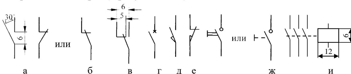
Рисунок 3.6 – Условные графические обозначения коммутирующих устройств (к пункту 3.3.2)
