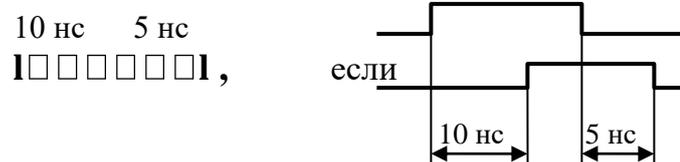
Рисунок 3.15 – Условное обозначение временной задержки
