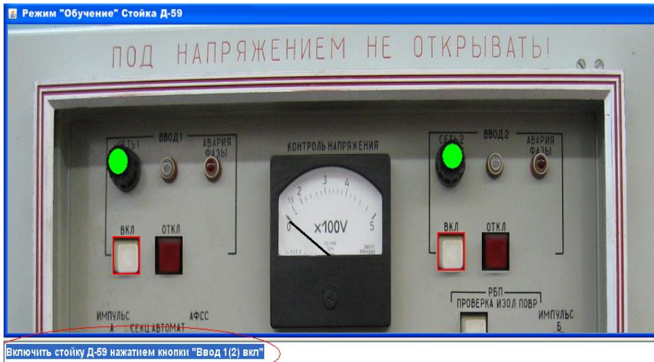
Рис. 8 - Типовое экранное изображение возникающие при работе на ЦТРС Р-423-1 в режиме «Обучение»
