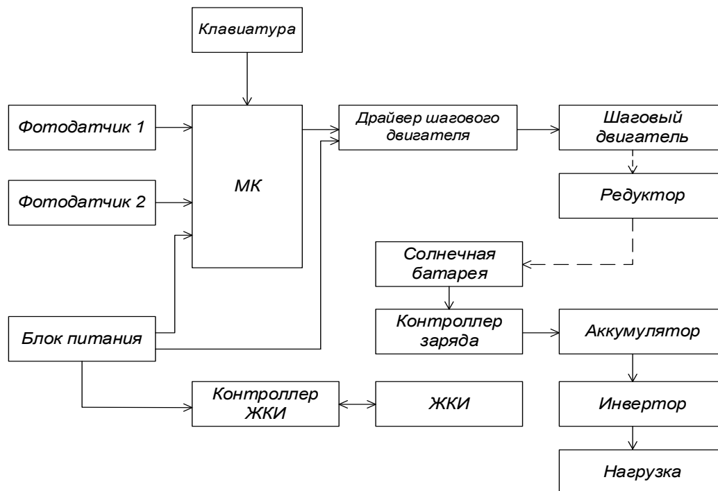
Рисунок 1 – Структурная схема системы позиционирования солнечной батареи на основе микроконтроллера
