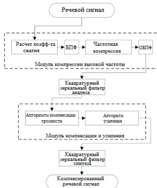
Рис. 1 - Структура системы компенсации громкости
