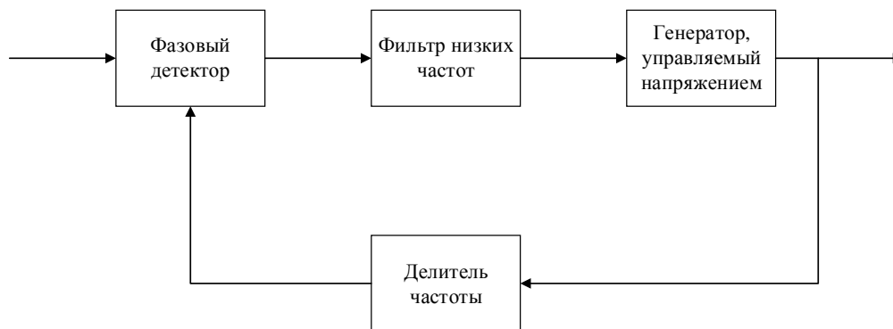
Рис. 2— Основная схема ФАПЧ
