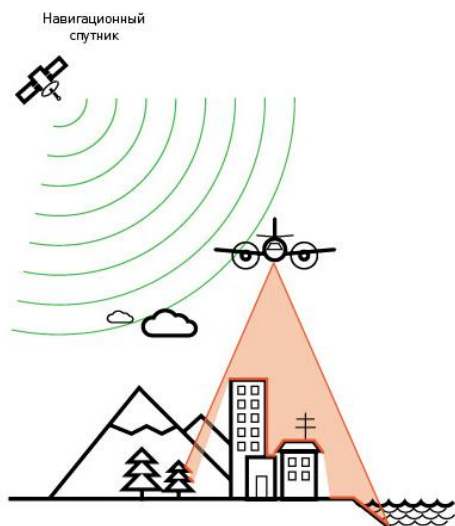
Рис. 1 – Воздушное лазерное сканирование, с использованием систем спутниковой навигации
