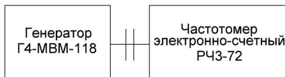
Рисунок 2 – Определение основной погрешности установки частоты в режиме непрерывной генерации
