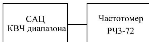
Рисунок 2 – Структурная схема для определения диапазона рабочих частот и относительной погрешности установки и отсчета частоты
