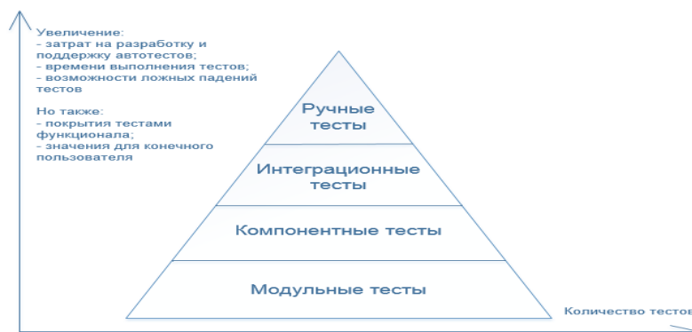
Рисунок 1 – Пирамида автоматизации тестирования (согласно Майку Кону)
